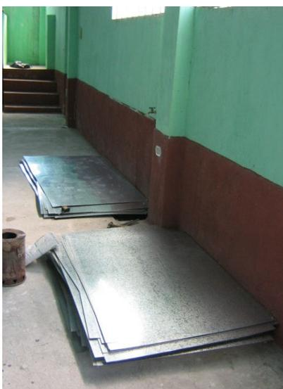
Figura 3.7. Lámina para la elaboración de silos en Santa Catarina Mita, Jutiapa.
