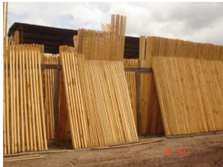
Figura II. 9 Secado natural de la madera, MARTISA, zona 7 ciudad de Guatemala, 2006. Fuente: él autor
