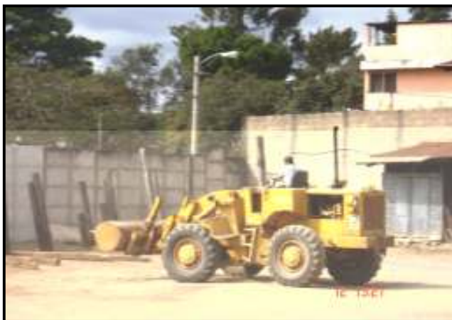
Figura II. 13 Sistema de transporte del patio de la troza a la sierra principal
