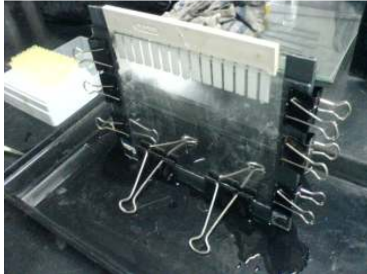
Figura 5. Equipo cargado con la poliacralamida y peine receptor de muestras.
