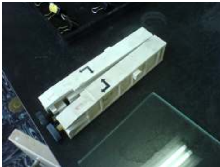
Figura 4. Pilares que sostienen las láminas de vidrio donde se vierte la poliacralamida.
