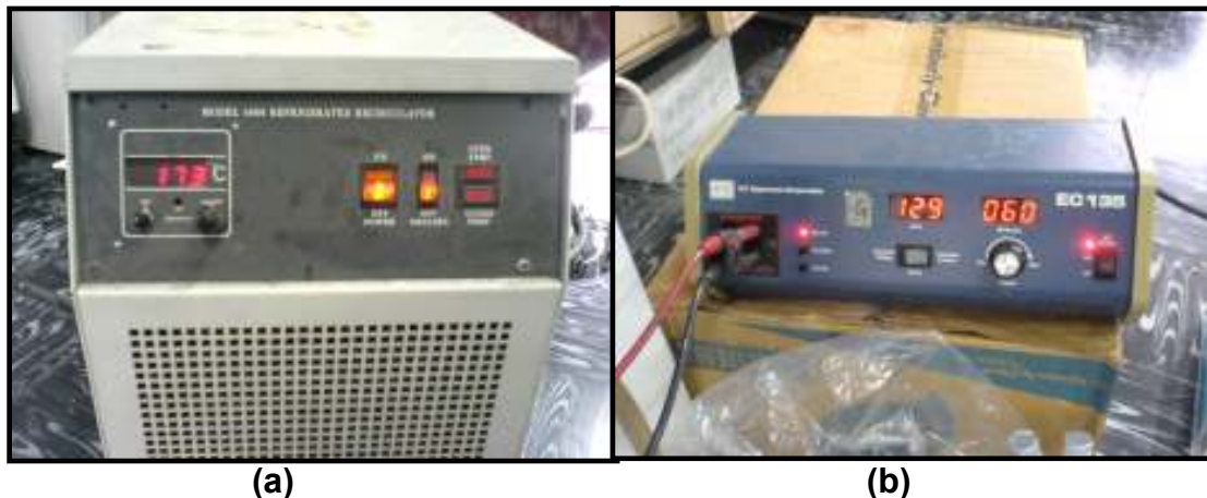
Figura 8. a) recirculador de agua fría y b) fuente de poder del sistema.
