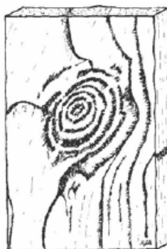
Figura 3. Nudo sano en madera aserrada .
