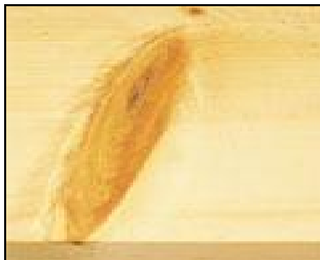
Figura 11. Nudo aserrado longitudinalmente.
