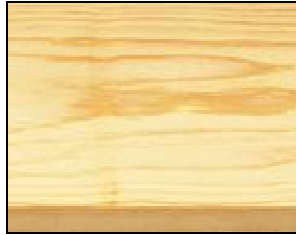
Figura 12. Arañazo de máquina en madera aserrada.
