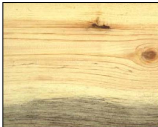
Figura 18. Mancha Azul en un trozo de madera aserrada de pino.
