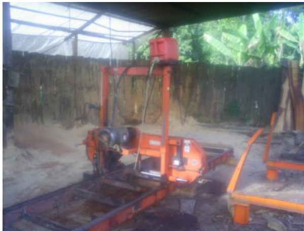
Figura 25. Aserradero tipo Wood Myzer utilizado en ASILCOM, 2008.
