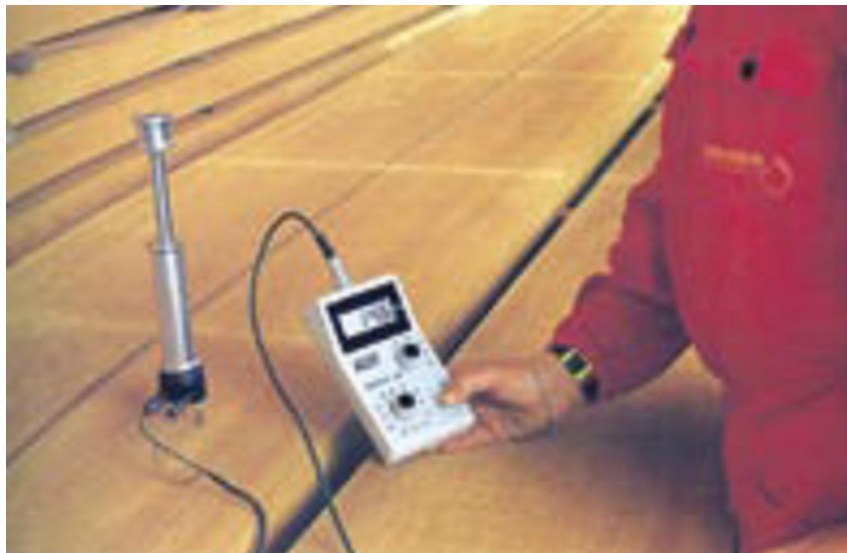
Figura 24. Xilohigrómetro, utilizado en la medición de humedad en madera.
