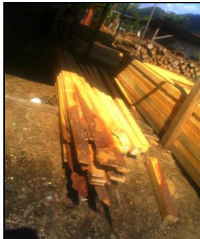
Figura 17. Entrecasco presente en madera aserrada.
