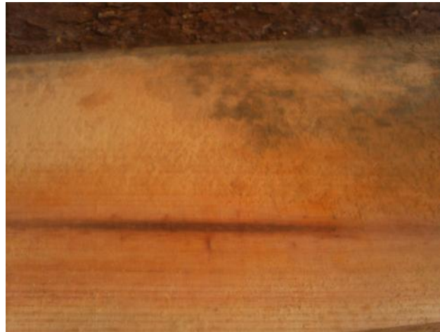
Figura 30. Médula excéntrica en la madera aserrada.
