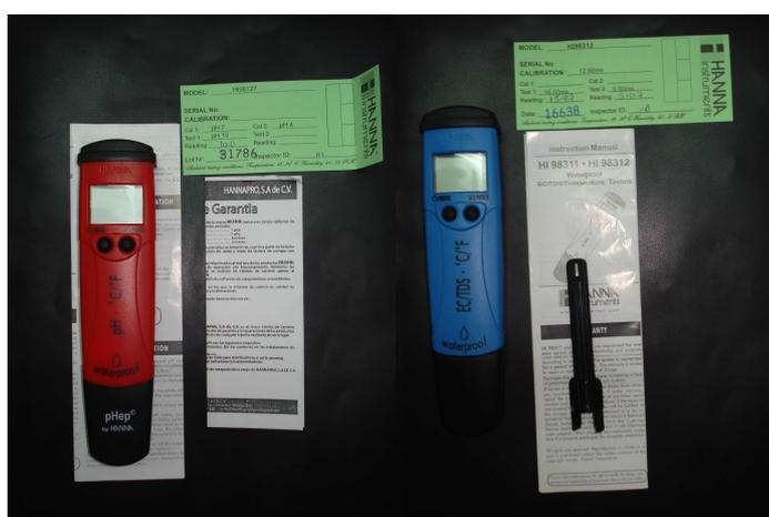
Figura 3.15 Potenciómetro y conductivímetro portátil.
