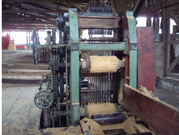
Figura 2. Sierra alternativa con las distintas sierras múltiples, Aserradero San Sebastián.
