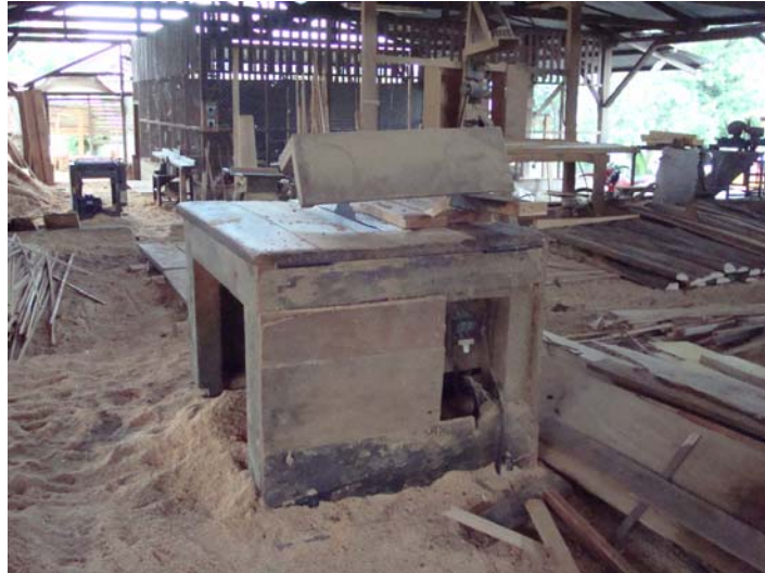
Figura 3. Sierra de banco para re-aserrado de madera, Aserradero San Sebastián.
