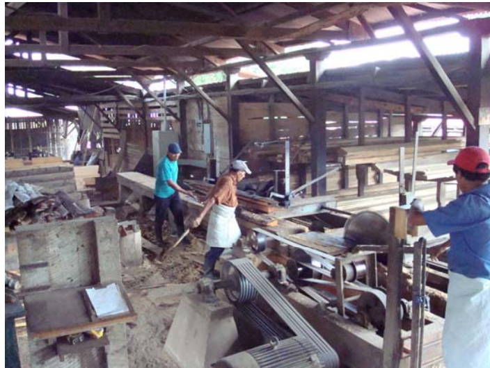
Figura 1. Sierra circular con los operarios haciendo cortes en escuadra a trozas, Aserradero San Sebastián.
