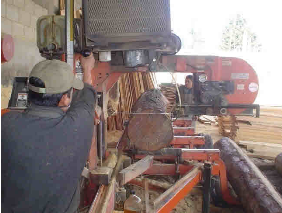
Figura 7 . Prueba con Aserradero portátil de cinta
