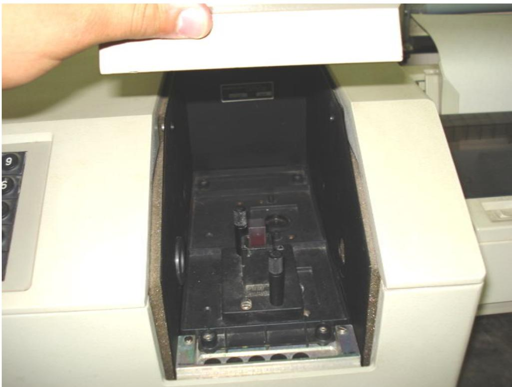
Fotografía 10 Colocación de celda de cuarzo de 10 mm de paso óptico en el espectrómetro
