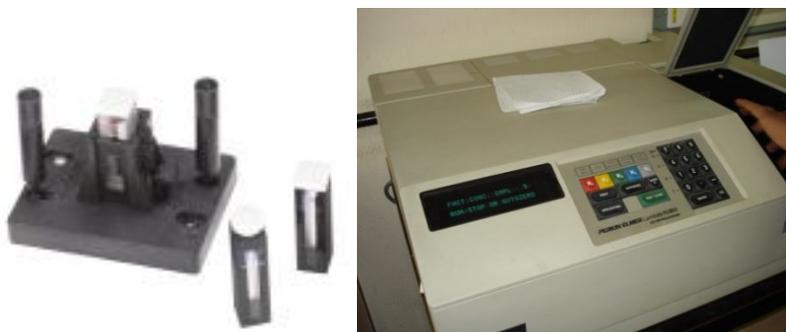
Ilustración 4 Espectrómetro Perkin-Elmer Lambda 11 y celdas de cuarzo de 10 mm.
