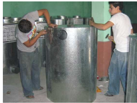
Figura. 3.3. Supervisión de la elaboración de silos metálicos en la bodega municipal de Santa Catarina Mita, Jutiapa
