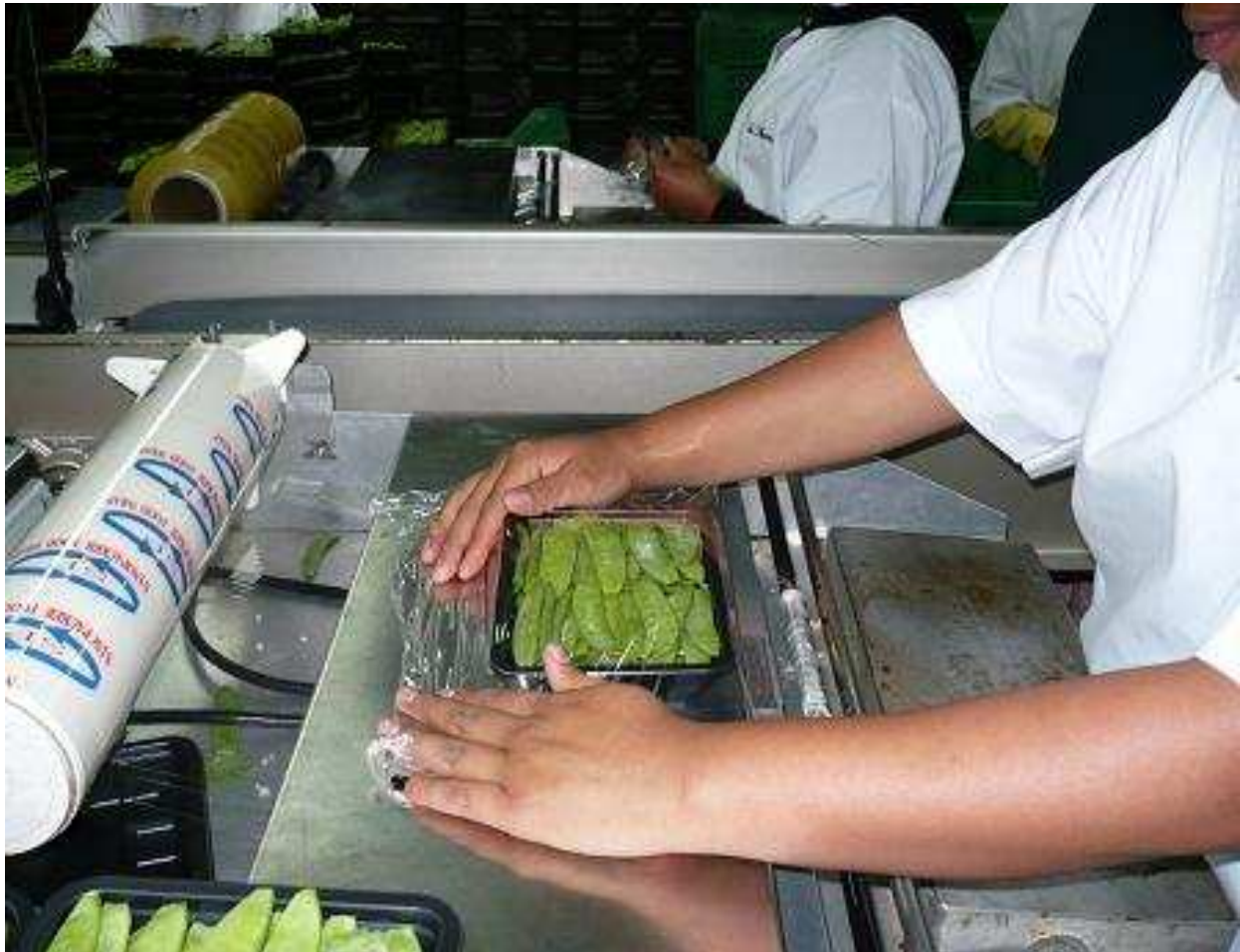
Figura 11. Proceso de sellado de la bandeja con la película de nylon delgado especial para este proceso.
