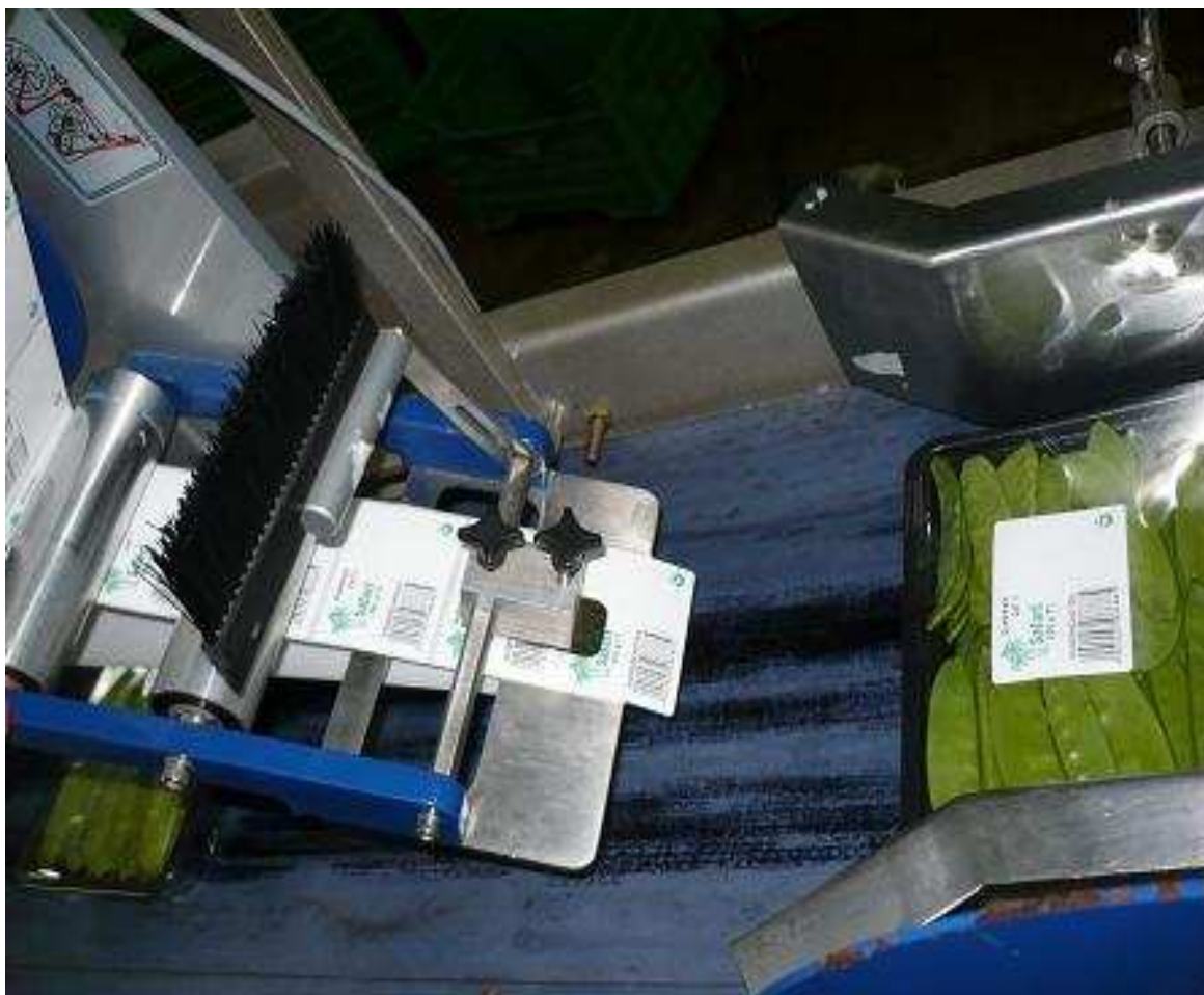
Figura 12. Máquina para etiquetado de bandejas de arveja china, después de que ha sido empacada.
