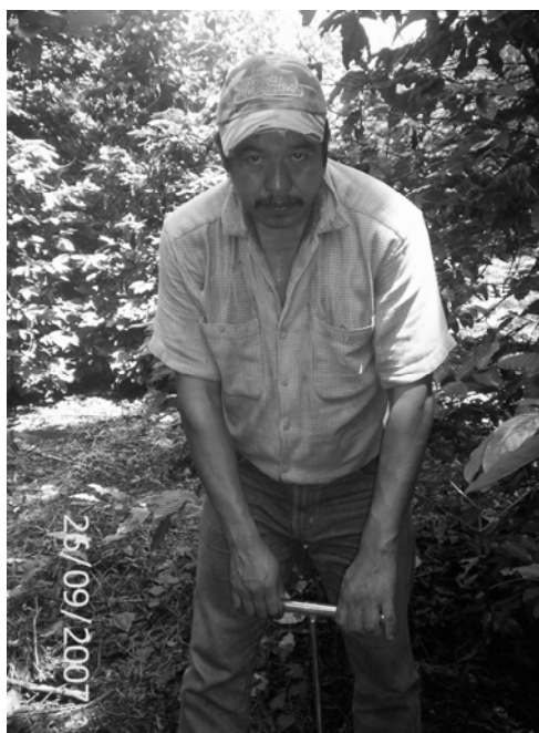
FIGURA 30. Realizando los barrenamientos para determinar la profundidad efectiva del suelo.
