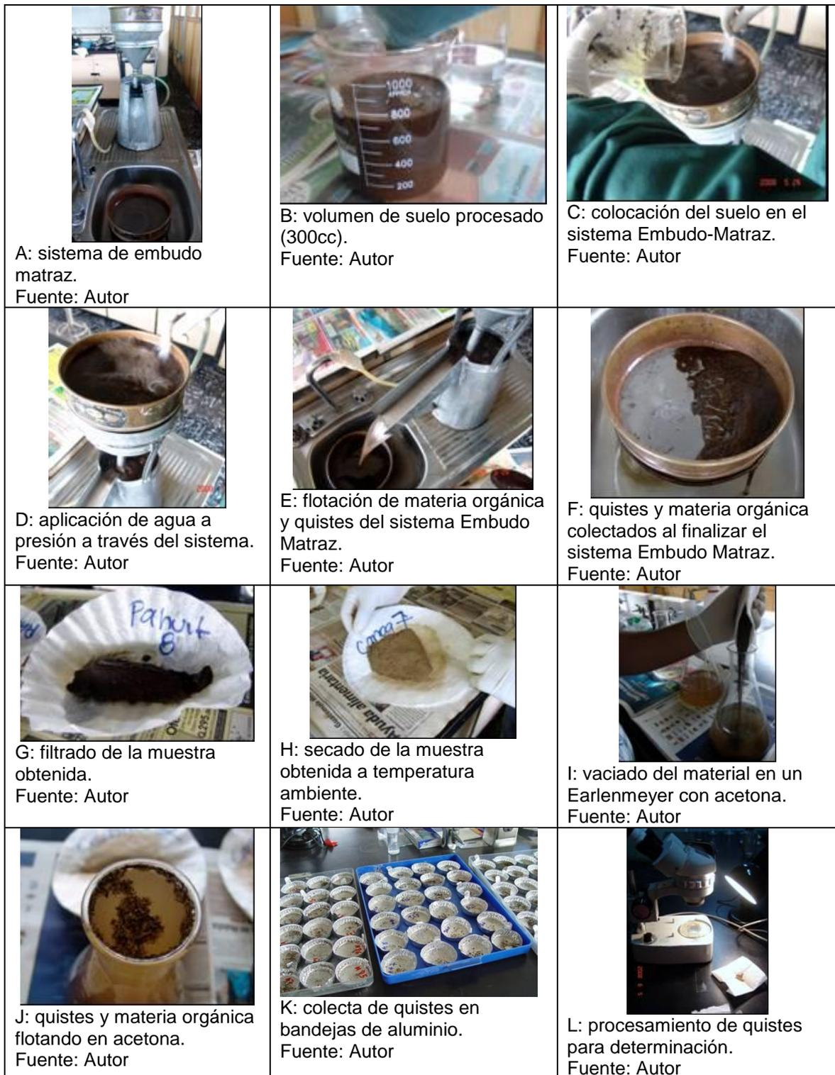
Figura 5: Flotación de quistes a través del método Fenwick, modificado con flotación en acetona.
