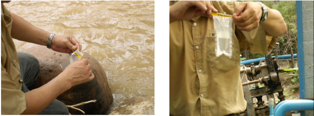
Figura 3.30. En la fotografía de la izquierda se muestra como se deben abrir las bolsas esterilizadas, previo a tomar la muestra de agua y en la fotografía de la derecha se muestra como se debe cerrar la bolsa plástica, para evitar la perdida de agua.
