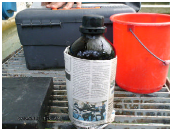
Figura 3.29 Ejemplo de envoltorio que se puede fabricar muy fácilmente y que cumple la función de aislar el contenido de la luz.
