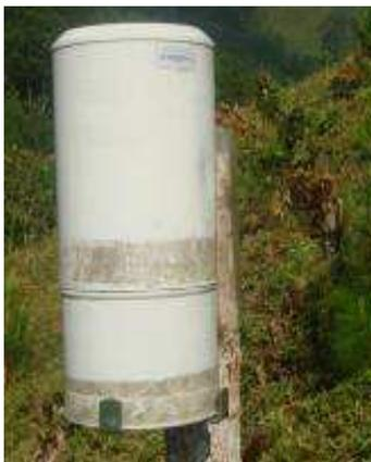
**Figura 31 Pluviómetro de Lambrecht**
