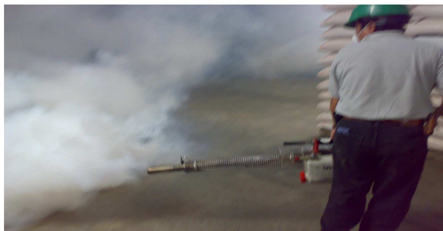
Figura 37: Aplicación de producto solfac con la termo nebulizadora para la prevención y erradicación de palomillas y otros insectos voladores presentes en la bodega de productos almacenados.
