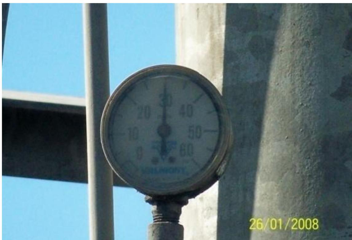
**Fig. 2.23** Manómetro midiendo presión de entrada de agua al pivote.
