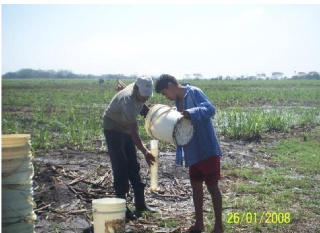
**Fig. 2.24** Lectura con probeta de una muestra de agua recolectada.
