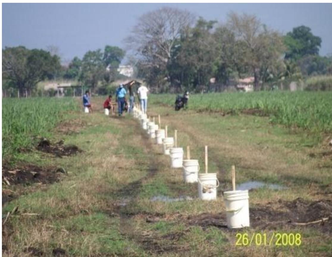
**Fig. 2.22** Metodología de medición del coeficiente de uniformidad.
