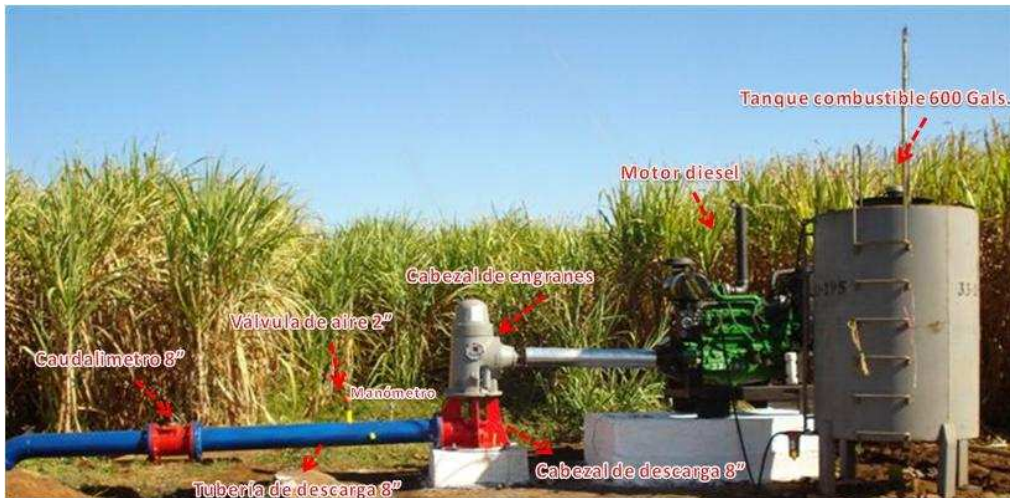
Figura 17. Componentes del sistema de bombeo.
