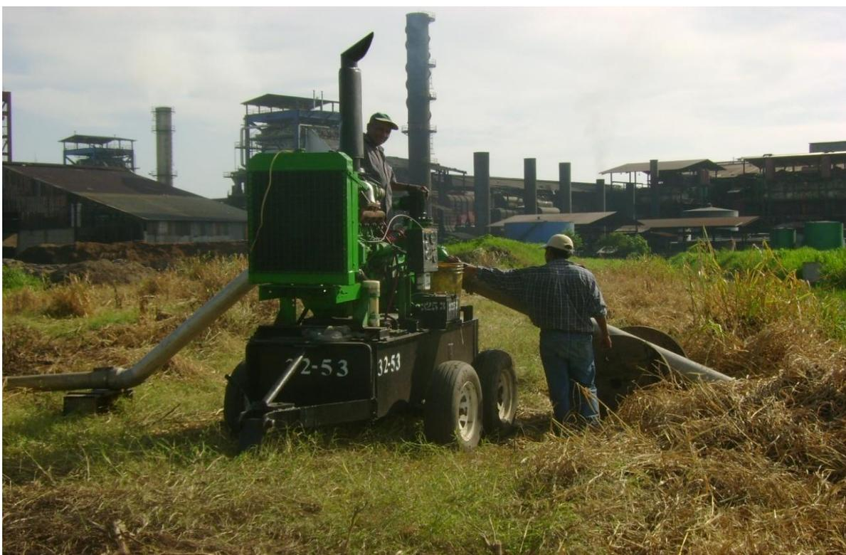
Figura 41A. Motobomba aspersion cañon y mini aspersion.
