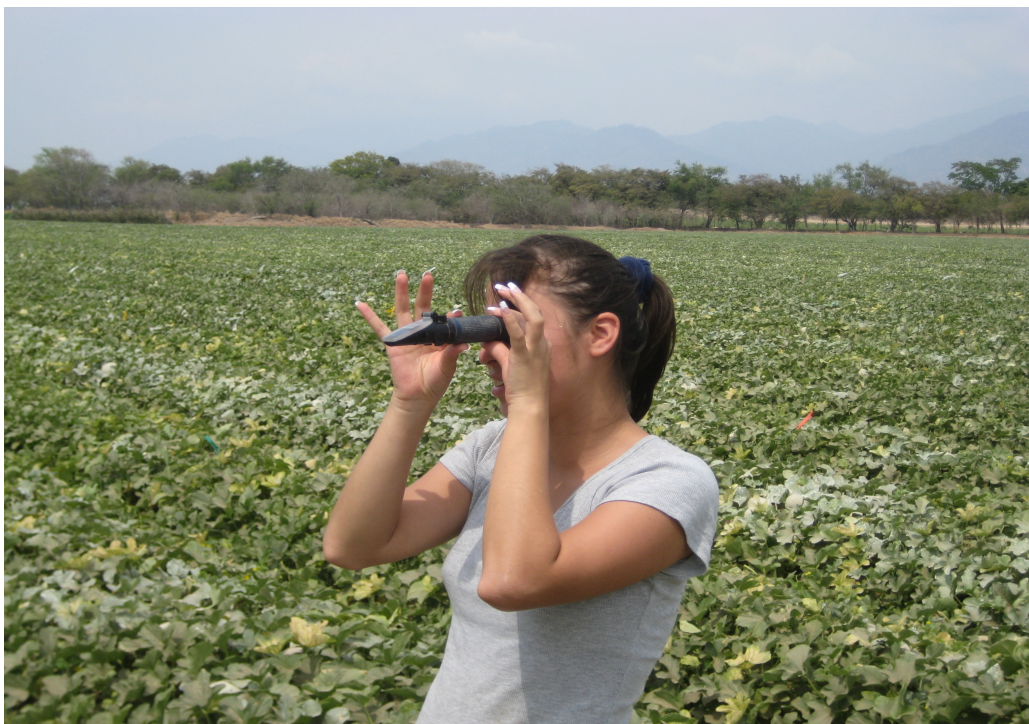
Figura 14 Tomando lectura de Grados Brix apoyada por el Refractómetro
