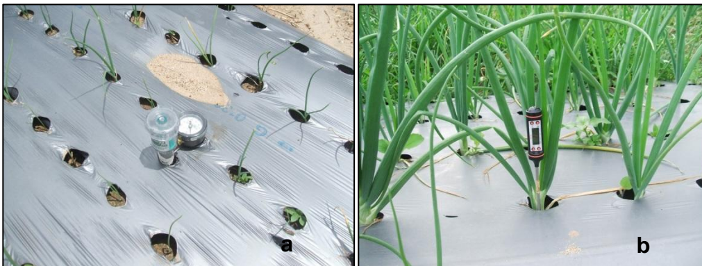
Figura 58 "A". Instrumentos para la toma de datos. a) Tensiómetro de humedad del suelo. b) Termómetro de vástago para medición de la temperatura del suelo.
