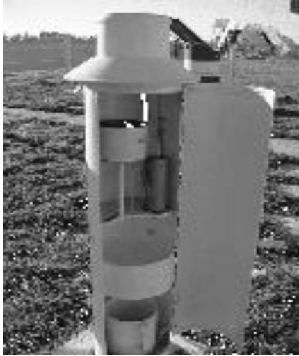
Figura 2. Fotografía de un Pluviógrafo instalado en campo y sus componentes
