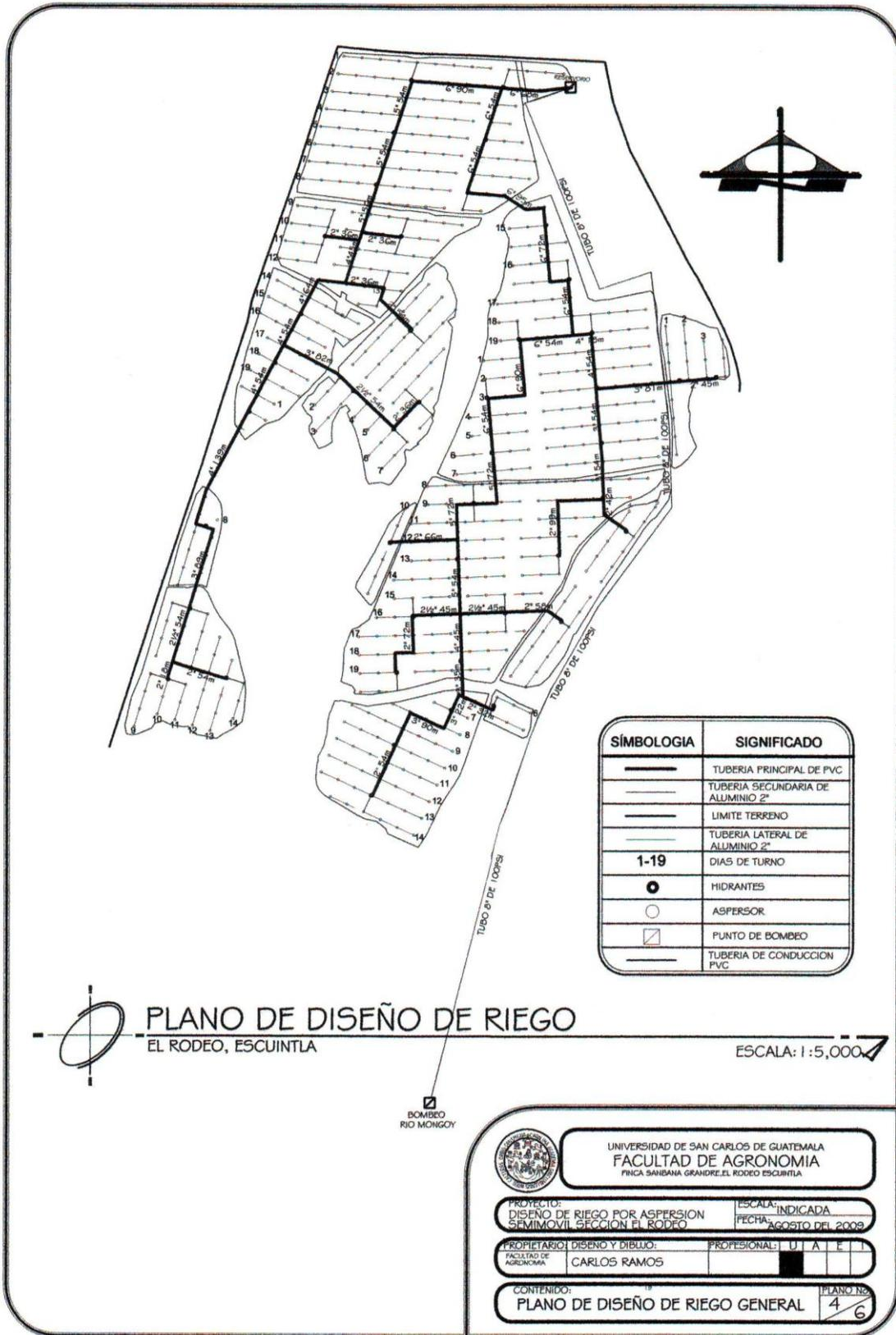
Figura 2.7. Plano de diseño de riego
