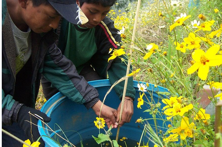
Figura 8 Medición de escorrentía utilizando una regla graduada. Fuente Reyes L.
