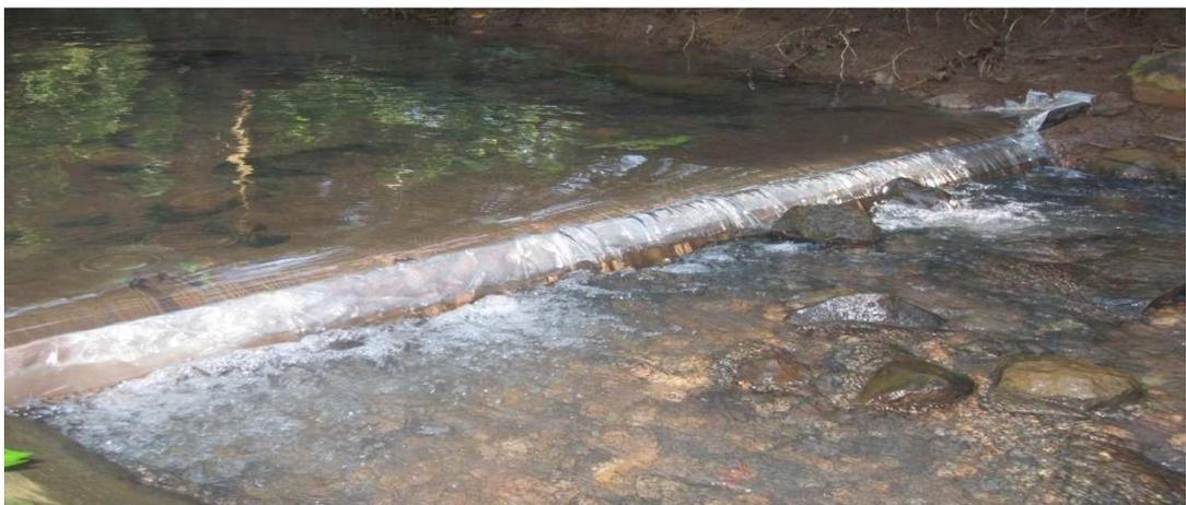
Figura 9 Método de aforo por vertedero.
