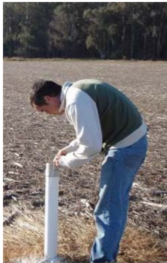
Figura 40. Forma de medir el nivel freático en campo Fuente Propia: José Alejandro Estrada 2011.
