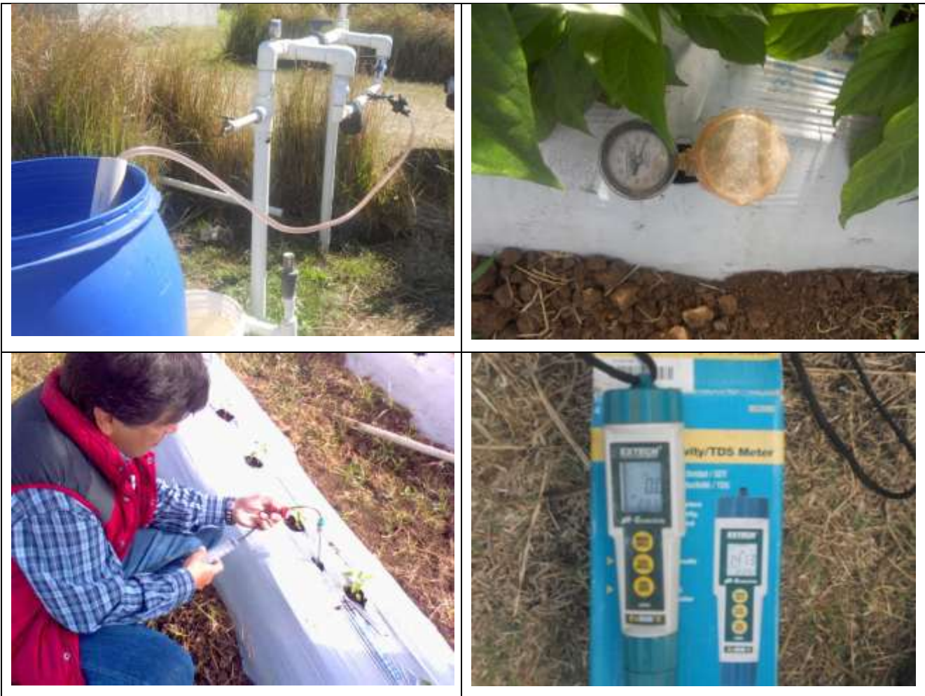
Figura 63. A) Caballete de riego por goteo con sus partes. B) Tensiómetro instalado en el macrotúnel de Chile. C) Chupatubos, para medir la tensión superficial. D) Conductímetro portátil. Fotos de Walter Herrera, 2010.
