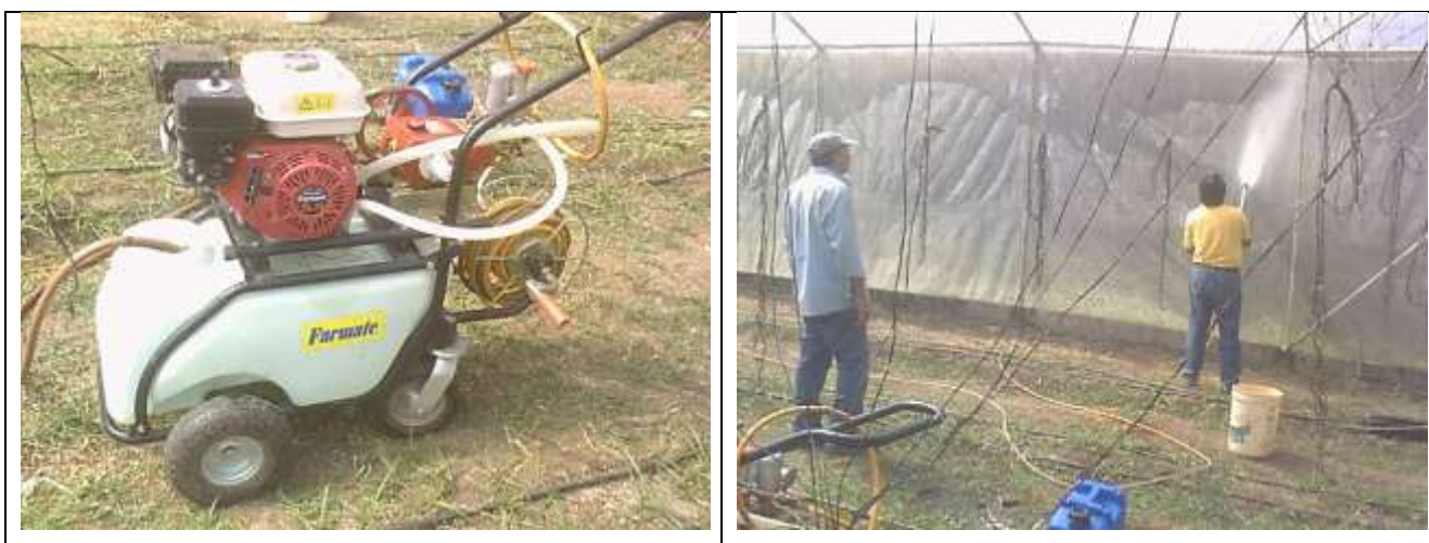
Figura 43. A) Vista de la máquina hidrolavadora con su depósito de agua y sistema de mangueras. B) Lavado de paredes de invernaderos. Fotos de Walter Herrera, 2010.
