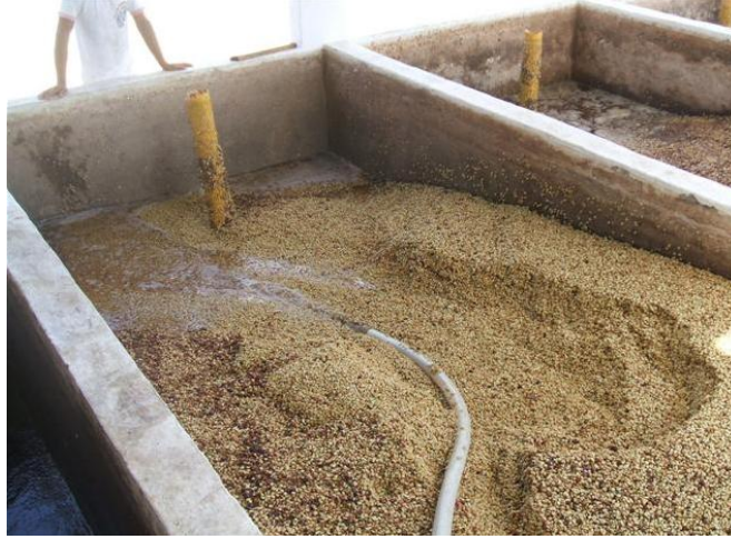
Figura 10 Vista de una de las siete pilas de fermentación con que cuenta la planta de beneficiado.
