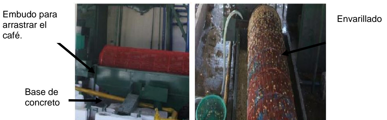
Figura 8 Vista de dos diferentes ángulos de la criba, separadora de flotes o clasificadora de pergamino.
