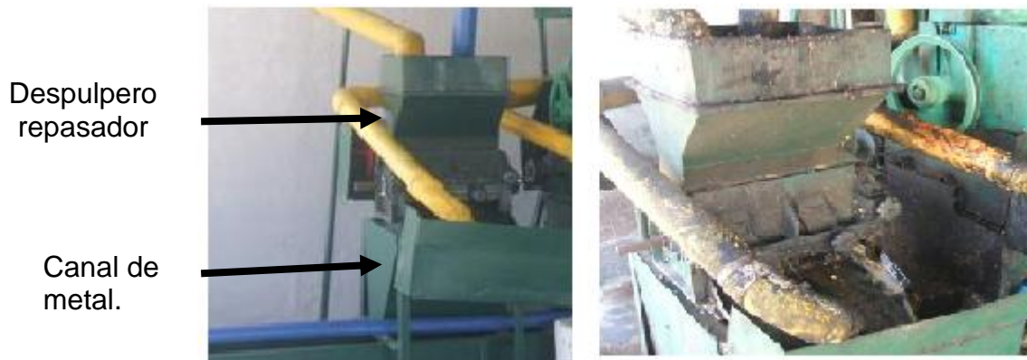
Figura 9 Despulpador repasador de café uva tanto en reposo como en funcionamiento.
