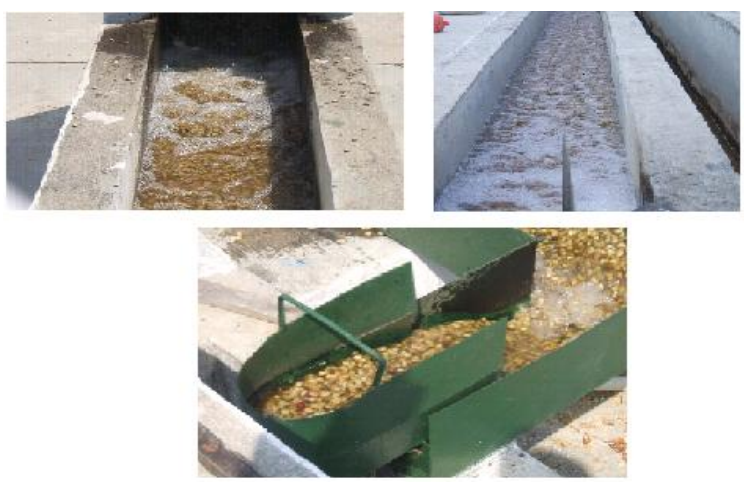
Figura 12 Sistema de canales y correteo para el lavado del café pergamino.
