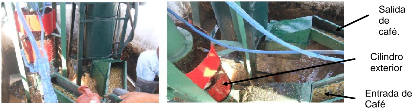
Figura 11 Desmucilagadora de café pergamino así como algunos de sus componentes.
