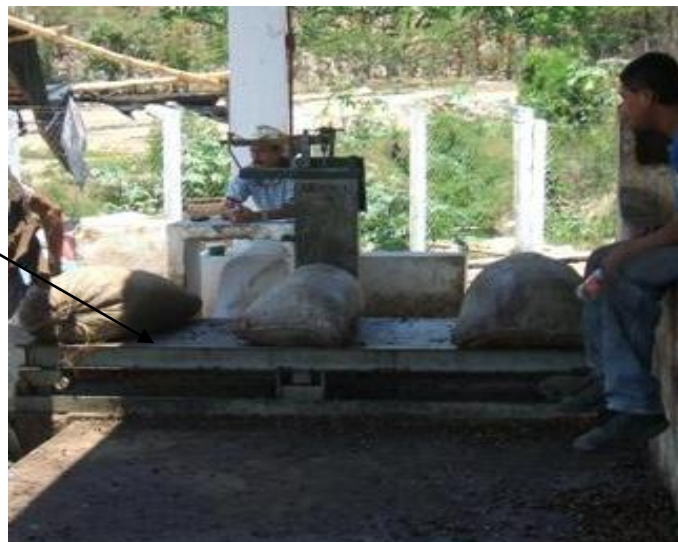
Figura 3 Báscula utilizada para medir el peso y la cantidad de café uva que es recibido en el beneficio.
