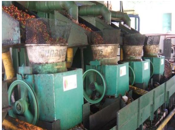
Figura 7 Vista lateral de los diferentes despulpadores existentes en la planta de beneficiado.
