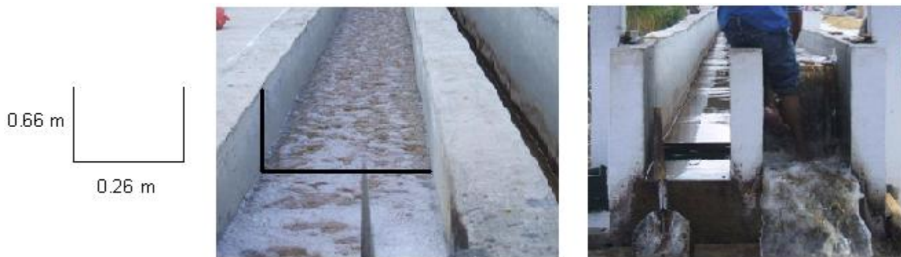
Figura 14 Caño guatemalteco para el transporte de pergamino hacia los patios de secado.
