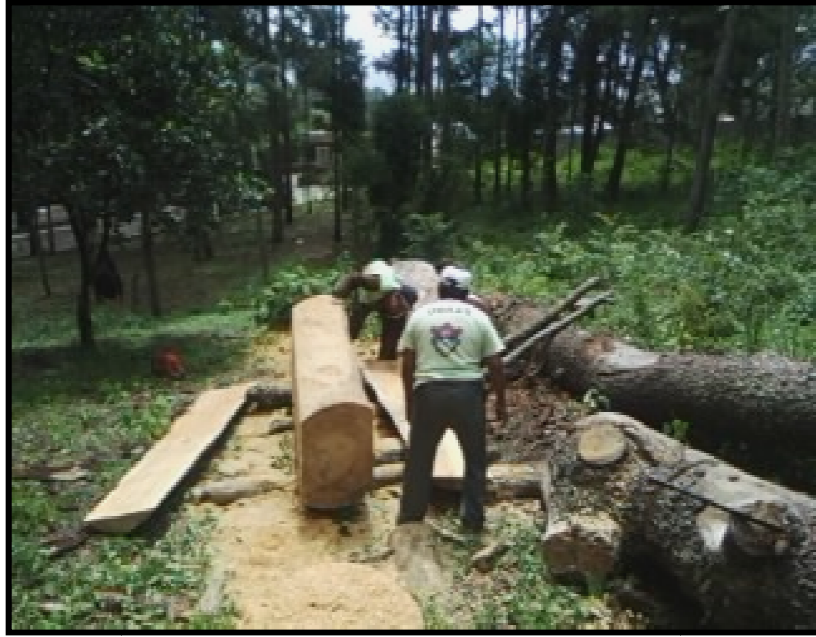
Figura 44. Corte de troza en árbol de pino para usarse en la elaboración de mesas. Autor: Mario Fernández
