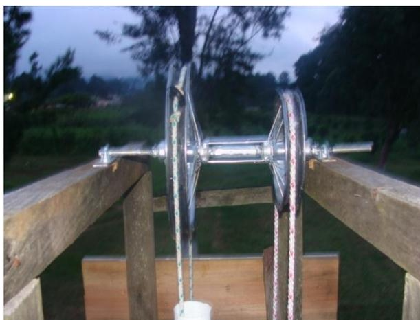
Figura 33 Nuevo sistema, incorporando una polea extra
