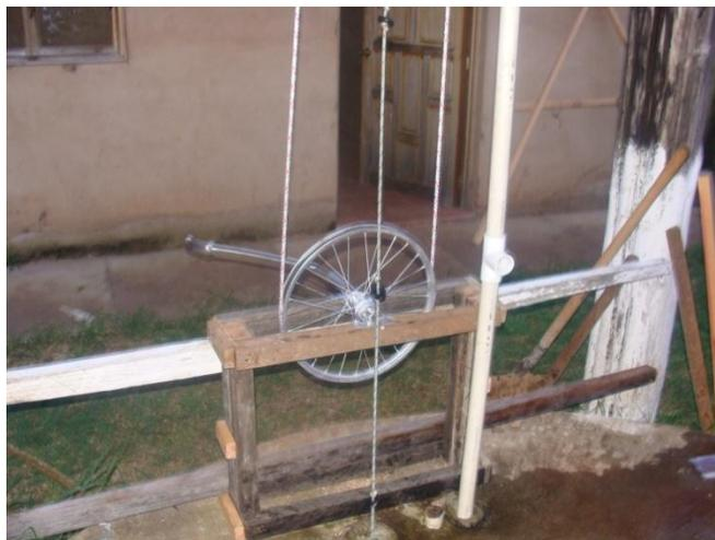
Figura 34 Nueva posición del maneral y salida de agua
