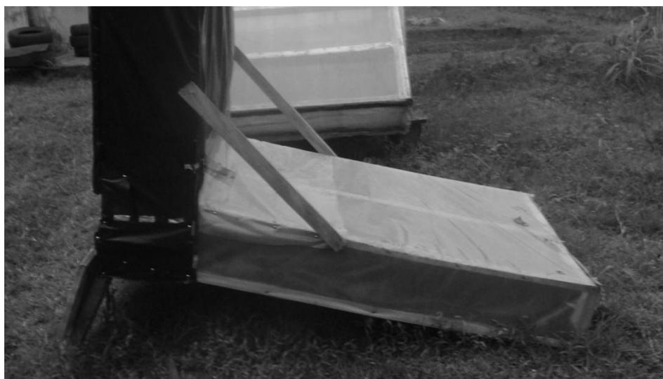
Figura 21. Cámara colectora forrada con plástico transparente, con fondo de lámina. Obsérvese la inclinación de la cámara colectora con respecto a la cámara de deshidratado.
