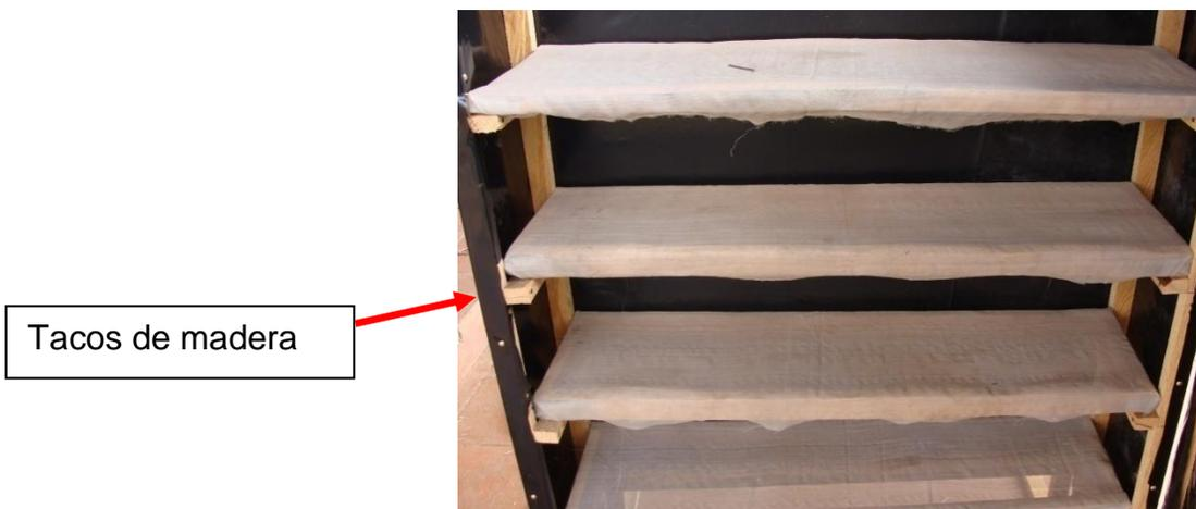
Figura 19. Bandejas de deshidratado colocadas sobre “tacos”.
