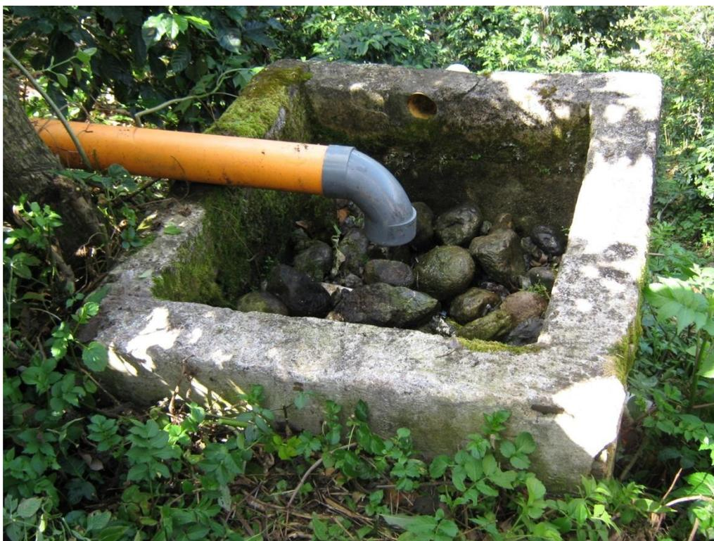
Figura 15. Fotografía de Filtro De Piedra y Arena del beneficio semitecnificado
