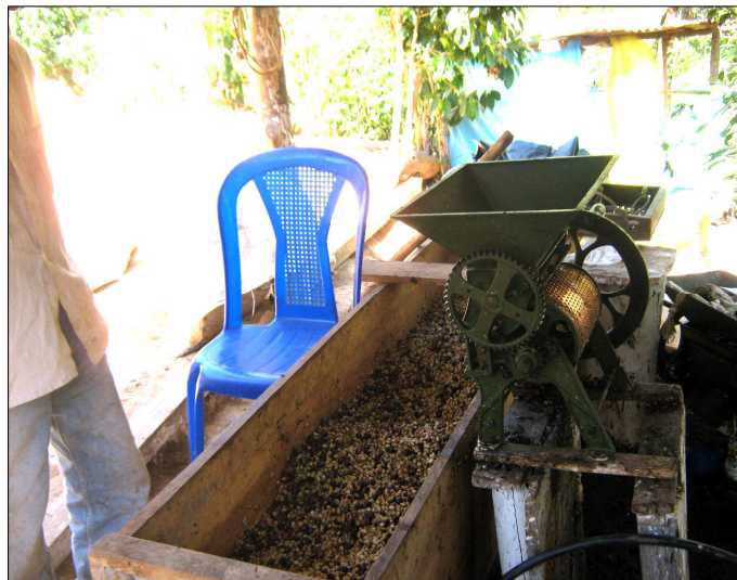
Figura 19. Recipiente donde se deposita el café luego de despulparlo para después lavarlo, (cajón). Finca El Recuerdo. Fuente: Elaboración propia
