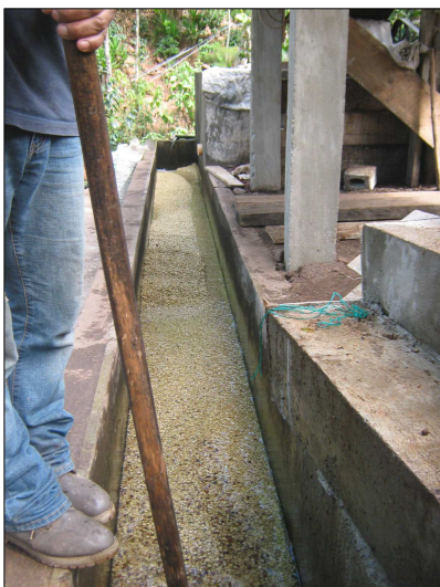
Figura 20. Canal donde se realiza el correteo para lavar el café despulpado. Finca La Esperanza. Fuente: Elaboración propia
