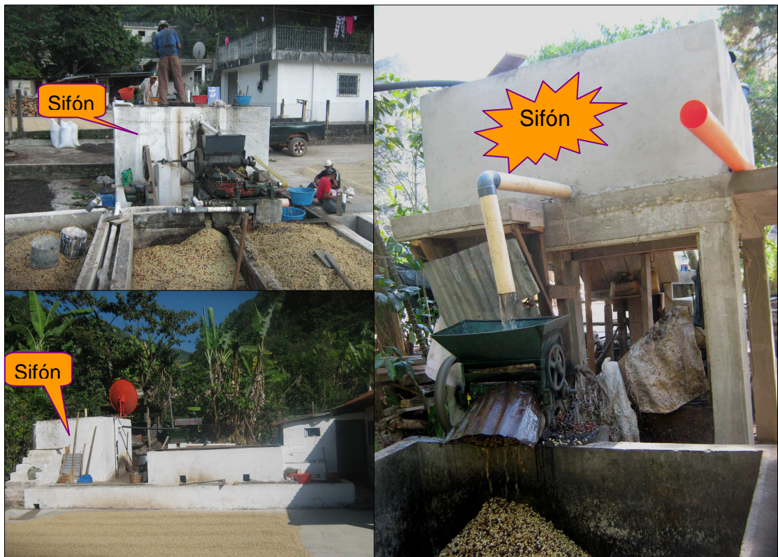
Figura 18. Algunas formas en que se instala un sifón en los beneficios. Fincas La Esperanza (arriba), El Naranjo (abajo), La Esperanza (izquierda).
