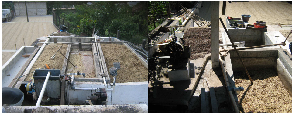
Figura 7. Algunos procesos que se llevan a cabo en el beneficiado, (pila de fermentación). Fuente: Elaboración propia. Fincas La Esperanza y El Consuelo
