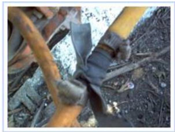
**Figura 1.5** Manguera en mal estado que conecta al sistema de descarga.
