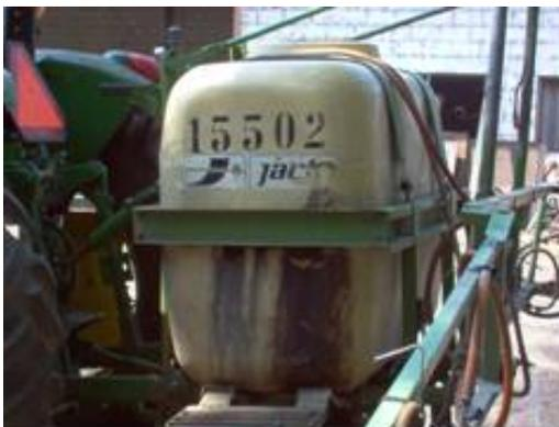
**Figura 1.3** Tanque de mezcla 15502 en mal estado
