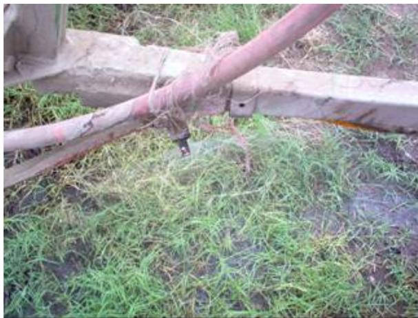
**Figura 1.8** Mala instalación de la boquilla del equipo a la estructura del aguilón.
