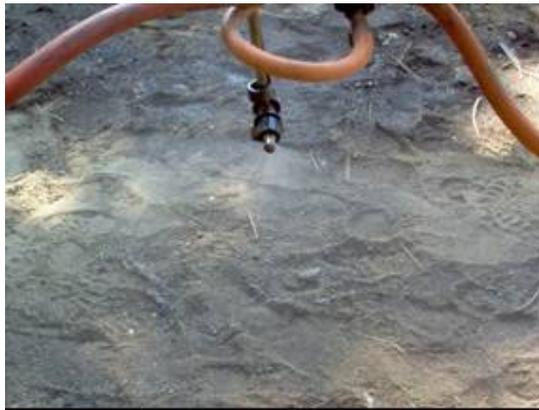
**Figura 1.7** Boquilla deteriorada por exceso de uso.
