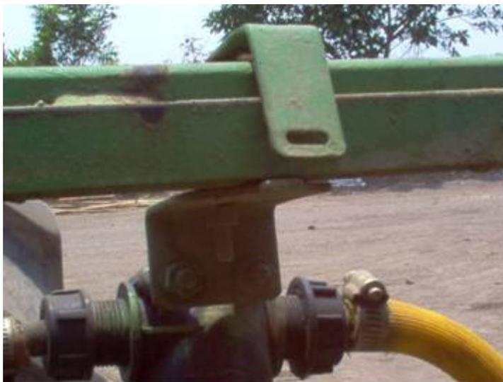
**Figura 1.2** Parte deteriorada de aguilón
