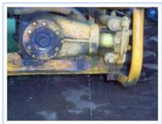
**Figura 1.4** Codo de entrada de la bomba en mal estado
