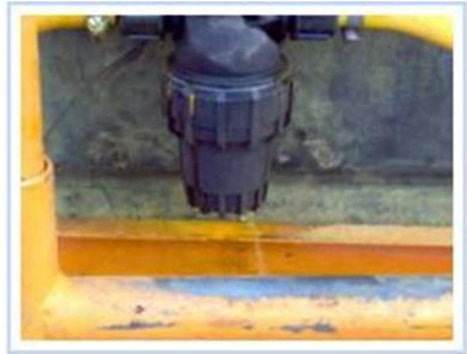
Figura 1.10 Accesorio taponado por mal lavado después de aplicación.
