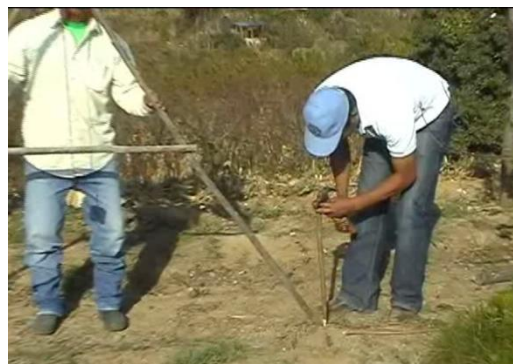
Figura 46. Calibración del nivel tipo "A".
