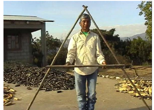
Figura 42. Fabricación de nivel tipo "A".
