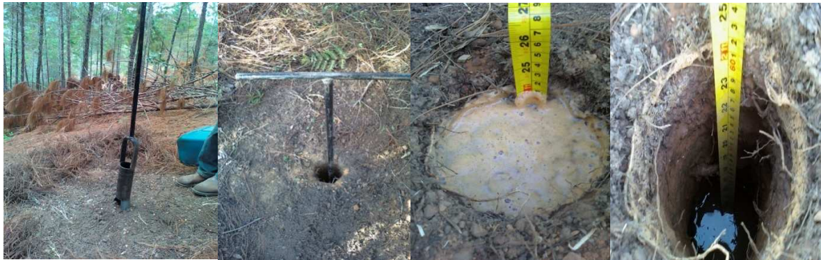
Figura. 28 Proceso de las pruebas en campo para la obtención de la infiltración básica mediante el método de Porchet.
