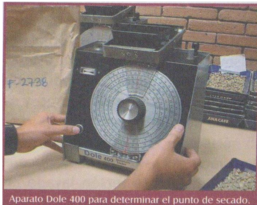
Aparato Dole 400 para determinar el punto de secado.
