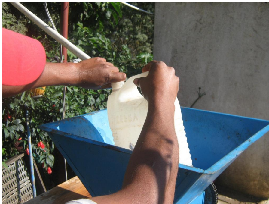
Figura 29. Fotografía del aforo de tubería de despulpado y lavado productor número 2 (productor pequeño)
