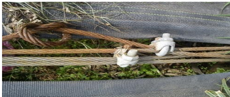
Figura 4. Componentes de tensado de cables (clams de 1/4”).
