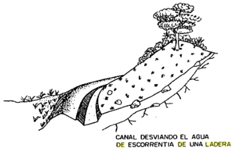
Figura 13. Canal desviando el agua de escorrentía.
