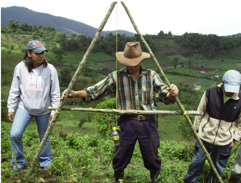
Figura 29. Nivel en "A" siendo usado por agricultores
