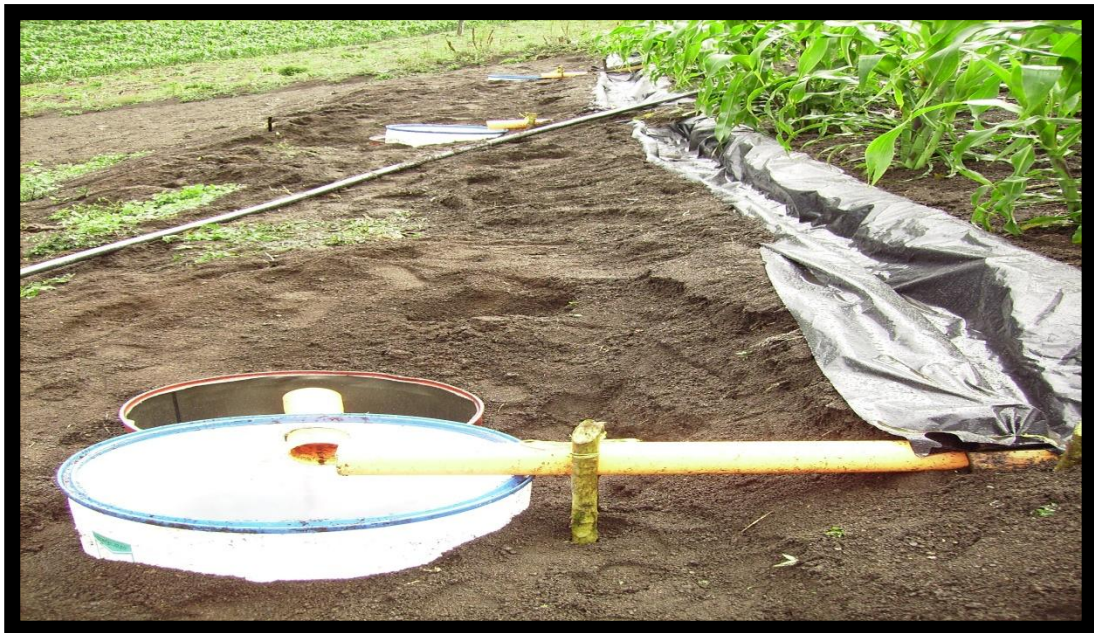
Fotografía 8. Recipientes colectores en y canal evacuador en parcelas de escorrentía
