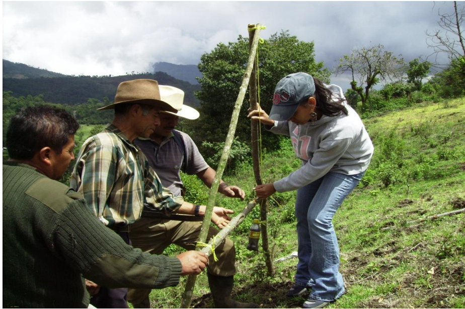
Figura 28. Calibración de Nivel en "A"
