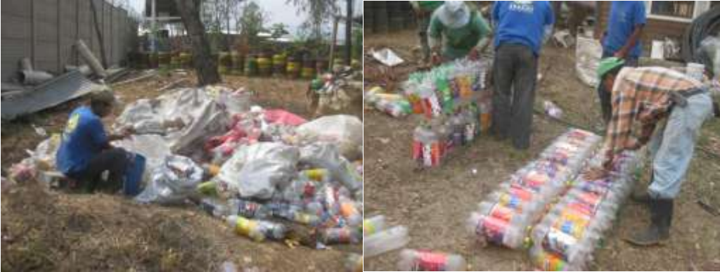
Figura 15.Recolección de material PET Figura 16.Construcción de módulos de lancha
