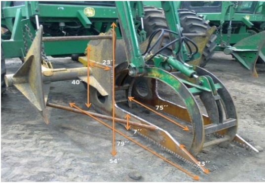
Figura 23. Dimensiones de un apilador tipo trineo en pulgadas
