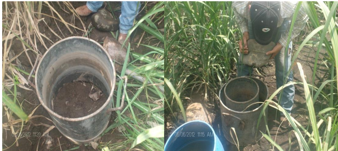
Figura 2.8 Instalación de cilindros de aluminio en el suelo.
