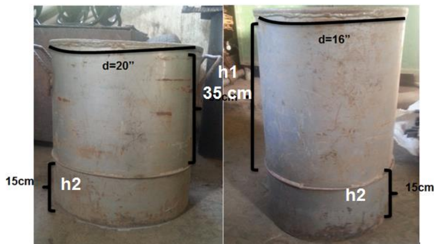
Figura 2.5 Dimensiones del infiltrómetro de doble cilindro utilizado en pruebas de infiltración, siendo d: diámetro en pulgadas, h1: altura superficial centímetros, h2: altura enterrada centímetros.
