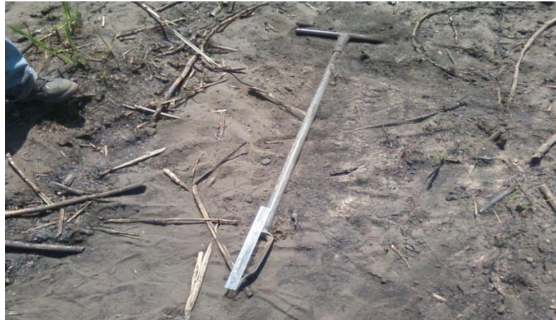
Figura 2.11 Barreno holandés para toma de muestras de suelo.
