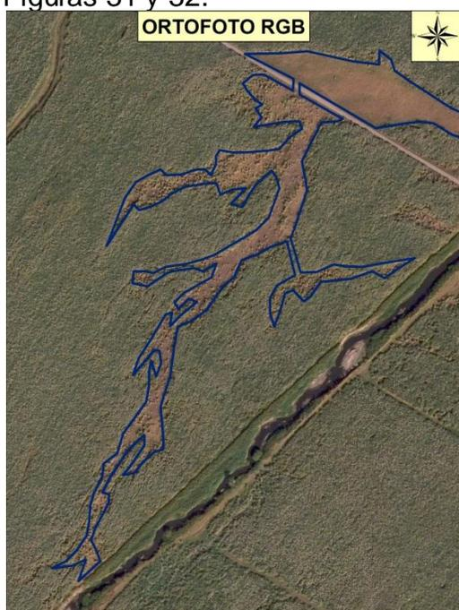
**Figura 31:** Digitalización de vetas de arena utilizando ortofoto tipo RGB
