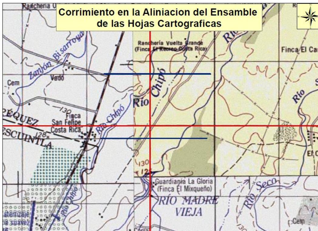
Figura 40: Mapa que muestra el mal ensamble de las diferentes hojas cartográficas dentro de una SID.
