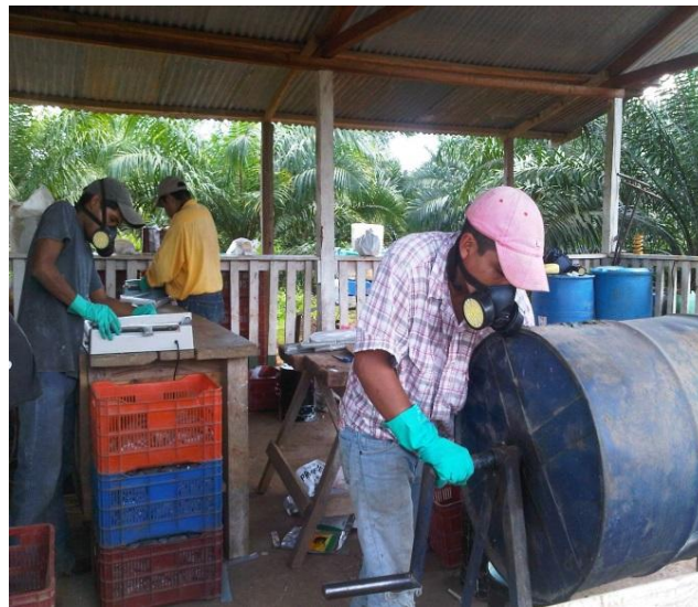
Figura 19. Homogenización de la mezcla, sellado con prensa eléctrica y estibada de cebos.
