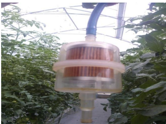
Figura 53: Filtro del sistema de CO 2 .
