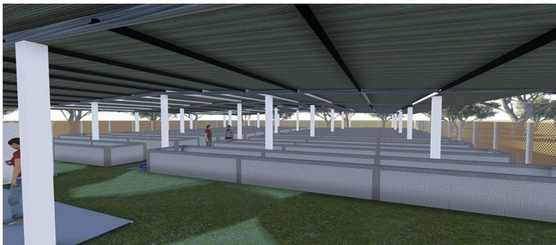
Figura 134: El techo está diseñado con costaneras y lámina, cubriendo toda El área de las composteras.
