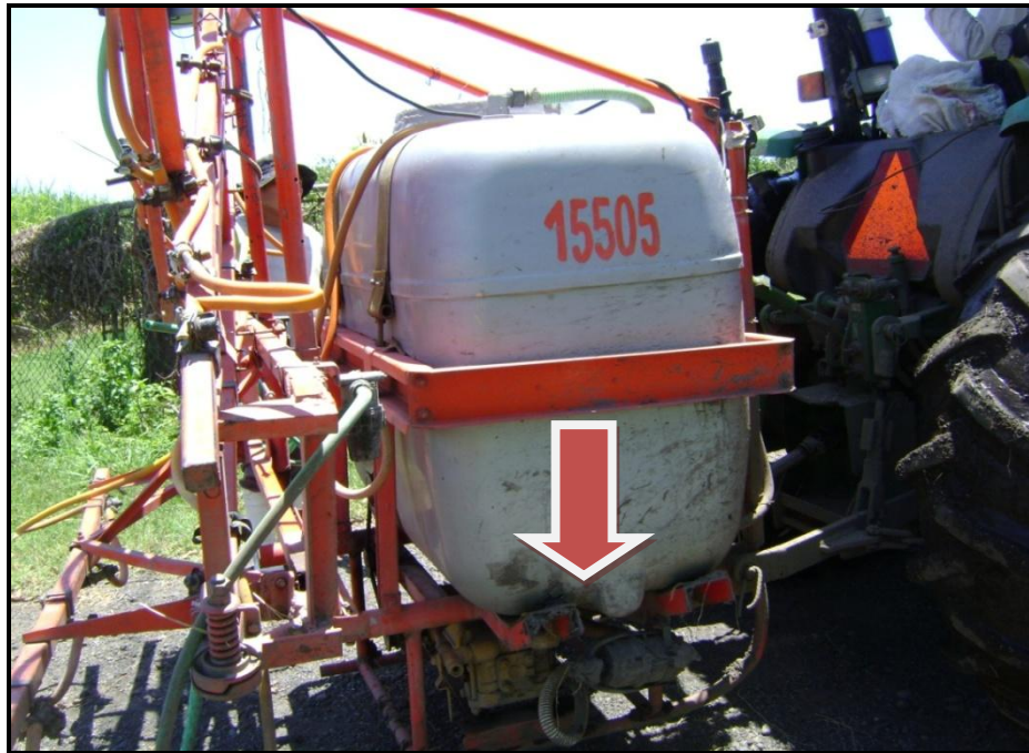
Figura 19. Tanque de mezcla 15505 con estructura quebrada
