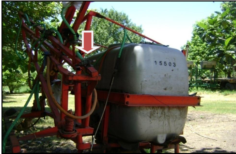
Figura 20. Mangueras con fugas
