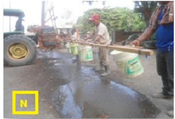
Figura 28. M) Encuesta a mayordomos y operarios de máquinas, N) Calibración previa de un aguilón, para verificar funcionamiento.
