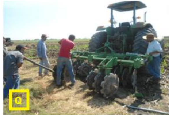
Figura 30. P) Descarga no uniforme, oscilación del eje del gusano en mal estado. Q) Calibración de una cultivadora, para verificar seccionamiento de discos traseros y evaluar funcionamiento.
