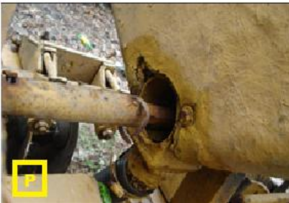
Figura 30. P) Descarga no uniforme, oscilación del eje del gusano en mal estado. Q) Calibración de una cultivadora, para verificar seccionamiento de discos traseros y evaluar funcionamiento.
