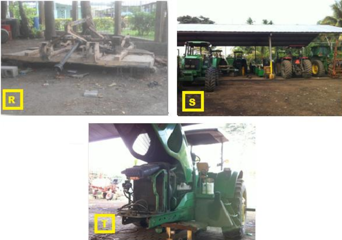
Figura 31. R) Chapeadora en mal estado y abandonada. S) Tractores de la región II en buen estado. T) Tractor de la región VII, en reparación por problema de calentamiento de motor. Fuente: El autor.
