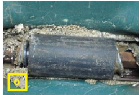
Figura 29. Ñ) Válvulas de flujo de tractor marca CASE, en buen estado. O) Problema de descarga no uniforme, causa, problema con el helicoidal del gusano y suciedad antes de iniciar el trabajo.
