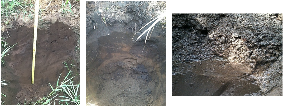
Figura 31. Cajuelas realizadas en área de vetas Finca Cantoira, Río Lindo y Pangola, a una profundidad de 60 cm.
