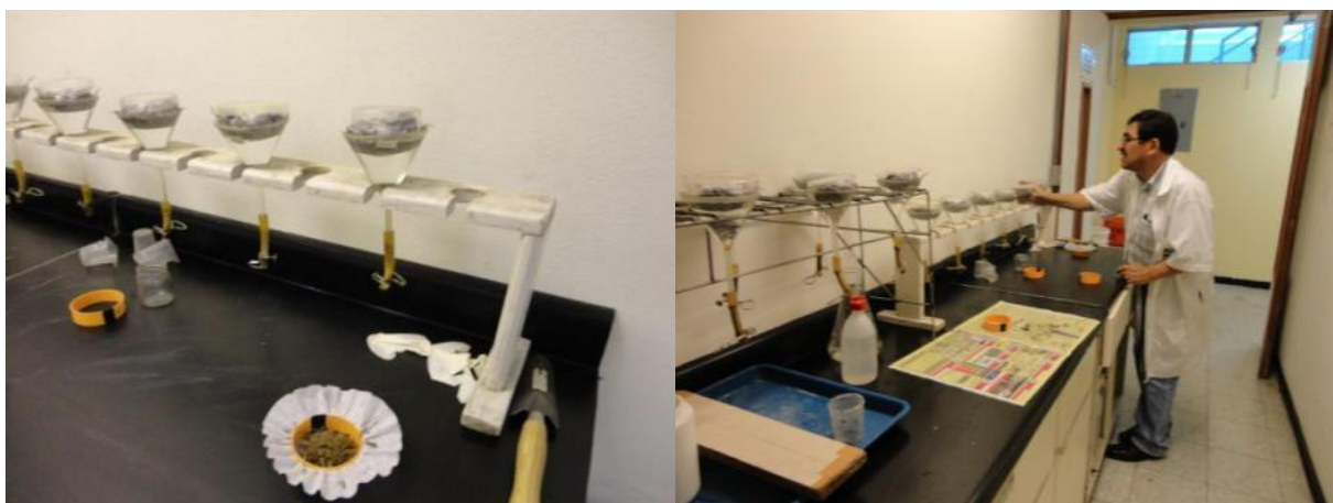
Figura 4 a) Colocación de muestras para extracción de nemátodos por el método del embudo de Baermann b) Embudos con muestras
