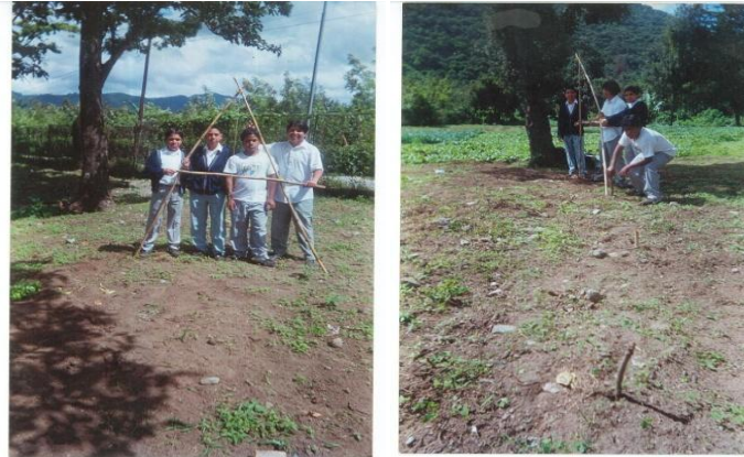
Figura 2 Alumnos realizando preparación nivel tipo A y trazo de curvas a nivel.
